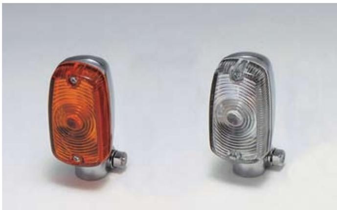
●アルミダイキャストボディで様々なスタイルのモーターサイクルに違和感なくスタイリッシュに取り付け出来るスリムタイプのウインカー。好みに合わせてアンバーレンズとクリアレンズの設定。さらにシングルとダブル球タイプを用意しました。
